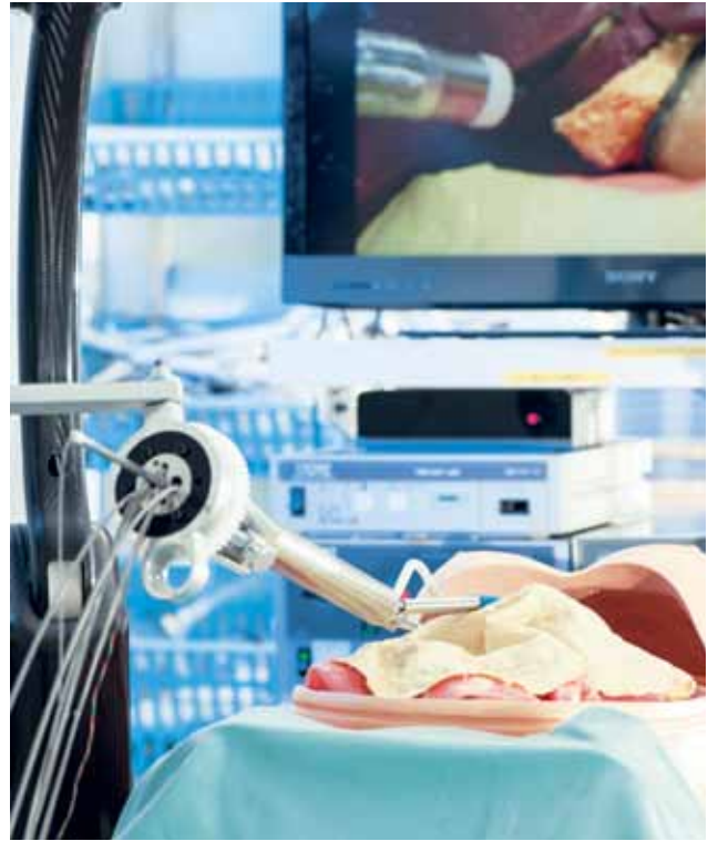
Im Experimental-OP testen Mitarbeiter von Feußner an einem in der Gruppe entwickelten wirklichkeitsgetreuen Kunststofforso den Manipulator HVSPS (Highly Versatile Single Port System) – ebenfalls eine Eigenentwicklung. Das System vereint Kamera und zwei Operationsärmchen in einem Instrumentensystem (Bild rechte Seite). Es ermöglicht Operationen über nur einen Zugang und ist somit eine mögliche Lösung für künftige narbenlose Eingriffe. In the experimental operating theater, members of Feussner's team test their Highly Versatile Single Port System (HVSPS) on a realistic plastic torso, also developed by the MITI group. The HVSPS combines a camera and two operating arms in a single manipulator (right). This enables procedures using just one access point and is thus a potential solution for scar-free interventions in the future
