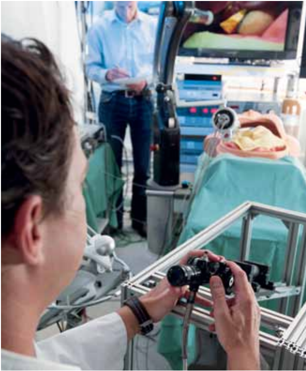
Im Experimental-OP testen Mitarbeiter von Feußner an einem in der Gruppe entwickelten wirklichkeitsgetreuen Kunststofforso den Manipulator HVSPS (Highly Versatile Single Port System) – ebenfalls eine Eigenentwicklung. Das System vereint Kamera und zwei Operationsärmchen in einem Instrumentensystem (Bild rechte Seite). Es ermöglicht Operationen über nur einen Zugang und ist somit eine mögliche Lösung für künftige narbenlose Eingriffe. In the experimental operating theater, members of Feussner's team test their Highly Versatile Single Port System (HVSPS) on a realistic plastic torso, also developed by the MITI group. The HVSPS combines a camera and two operating arms in a single manipulator (right). This enables procedures using just one access point and is thus a potential solution for scar-free interventions in the future
